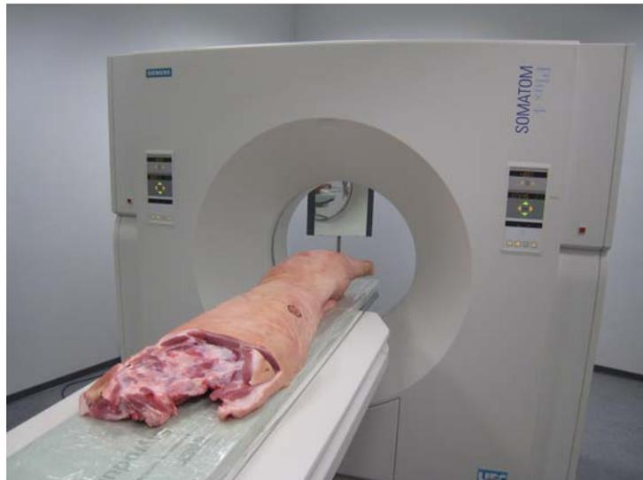
Abb. 1: Der Röntgen-Computertomograph wird zukünftig das Referenzgerät für die Bestimmung des Muskelfleischanteils sein. Hierdurch werden Gerätetests und Formelprüfungen schneller möglich sein.
