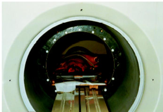
Ermittlung des wahren Fleischanteils mittels Magnet-Resonanz-Tomographie
