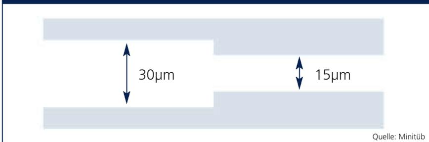
ten Bedingungen bei der Analyse können mit dem eFlow-System noch präzisere Untersuchungsergebnisse erreicht werden als zuvor mit der konventionellen Messkammer. Die Spalthöhen werden zu Beginn eines jeden Produktionstages mit Hilfe eines Softwaremoduls kontrolliert, um die korrekte Funktion der eFlow Messkammer zu gewährleisten. Die Messpositionen innerhalb der Kammer sind für alle untersuchten Proben identisch und werden automatisch angesteu-
