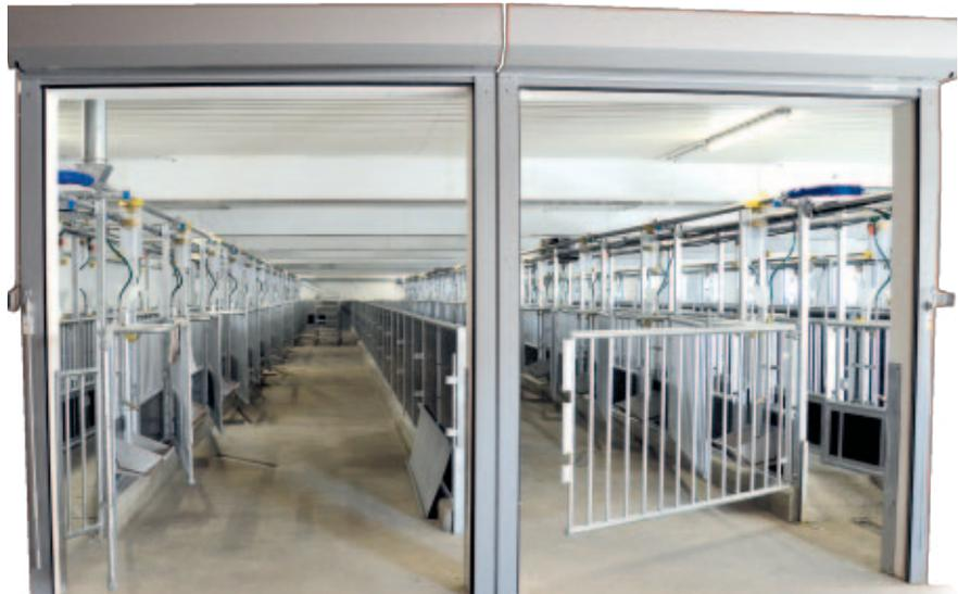
Blick von vorn in die Buchtenreihen. Zum Ausmisten werden die Gitter an die Seite geklappt, während die Eber auf den Laufgängen abgesperrt werden.
